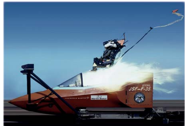
Martin baker JSF-F35 test Sled
